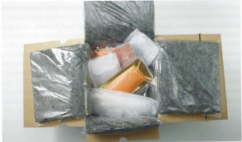
Neuentwicklung »Smartliner« im Einsatz bei Deutsche See: Das Kunststoffvlies wird zusammen mit Kühlpacks in die Versandbox eingelegt. Die Lösung gewährleistet die Solltemperatur für den definierten Versandzeitraum.
