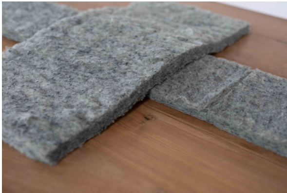
Das neuartige Kunststoffvlies für die Verpackungslösung „Smartliner“ von Ecocool (Bildquelle: Ecocool)
